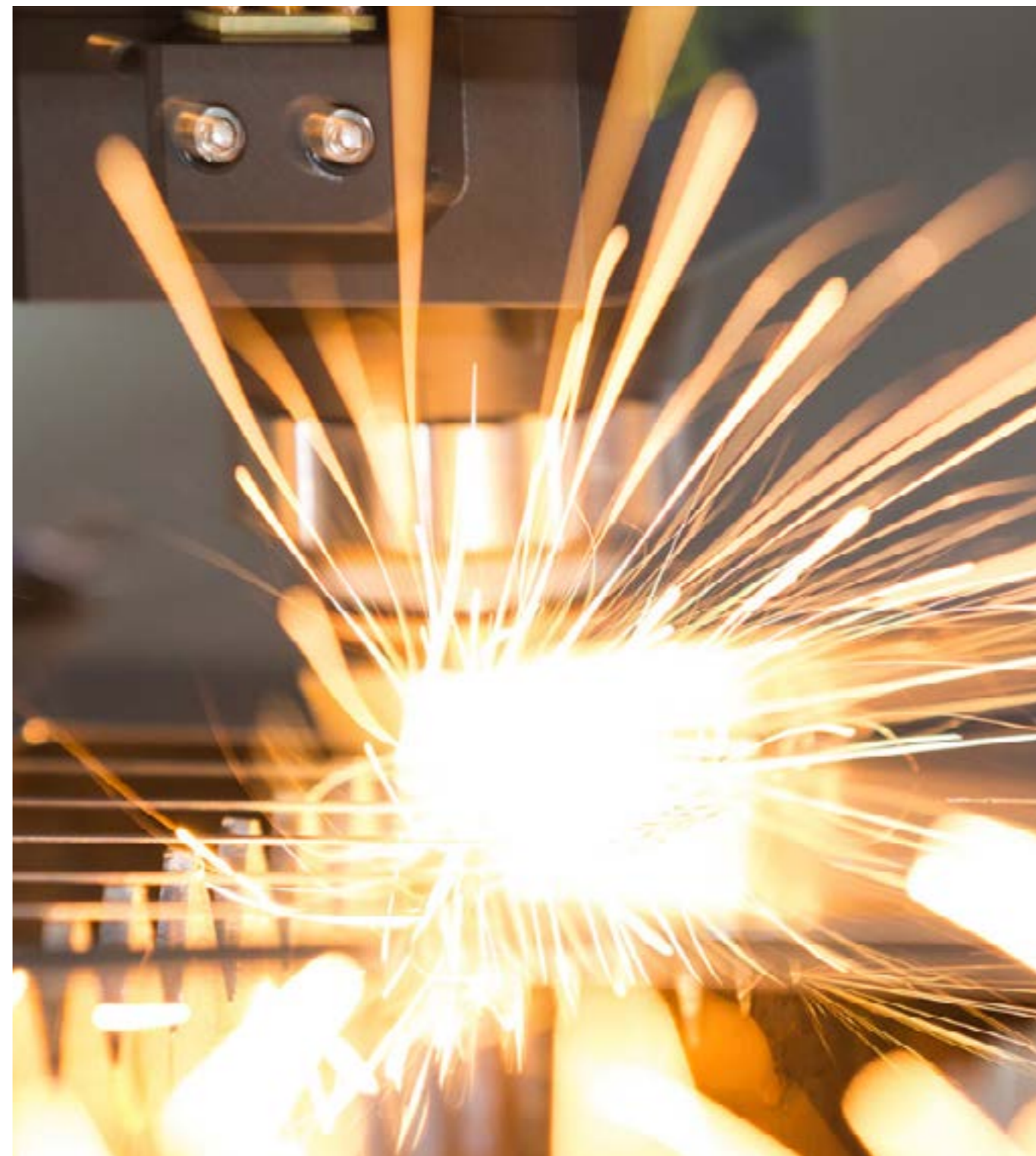
Cellule de fabrication du projet EPROM 2025 reposant sur la technologie Wire Laser Additive Manufacturing (WLAM), permettant la production de pièces métalliques par dépôt de fil fondu au laser.
